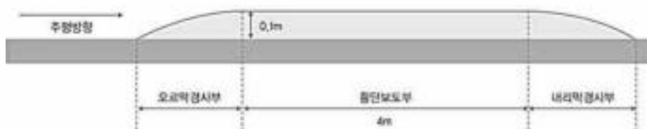
<그림 4-10> 고원식 횡단보도 형상 및 제원
