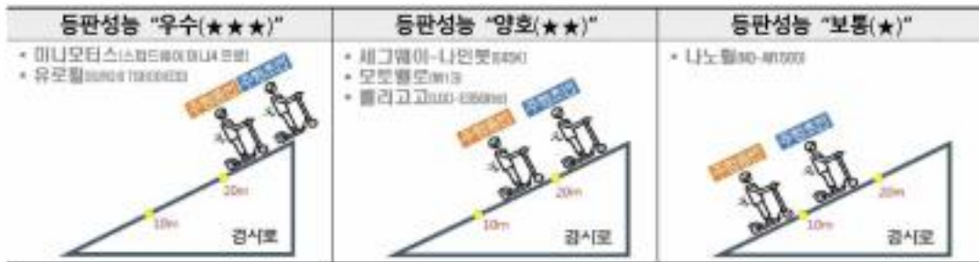
출처: 전동킥보드 품질시험 결과(2021.9.1.) 한국소비자원 시험검사국 기계금속팀 <그림 8-14> 등판성능(10도) 평가
